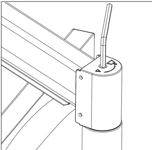
Ajustez le bras flexible en le vissant dans le sens des aiguilles d'une montre à l'aide de la clé Allen fournie.
