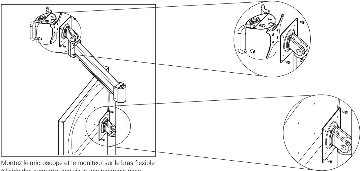
Montez le microscope et le moniteur sur le bras flexible à l'aide des supports, des vis et des poignées Vesa.
