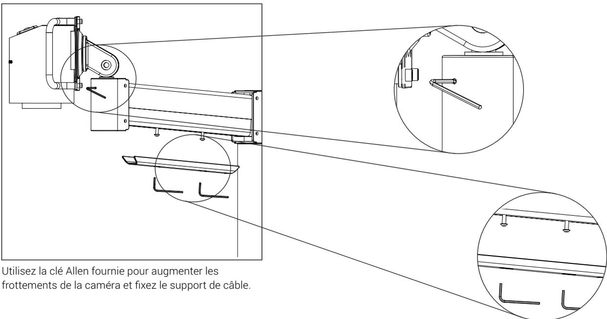
Utilisez la clé Allen fournie pour augmenter les frottements de la caméra et fixez le support de câble.
