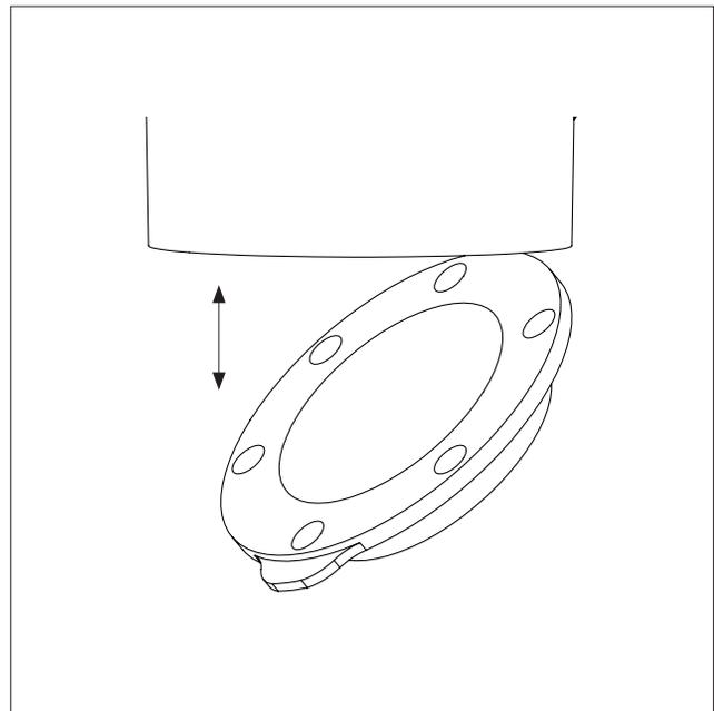
Positionieren Sie die Linse und den Linsenring unter dem Kamerakopf, so dass der Magnetiklinsen-Ring und der Stahlring ordnungsgemäß miteinander verbunden sind.
