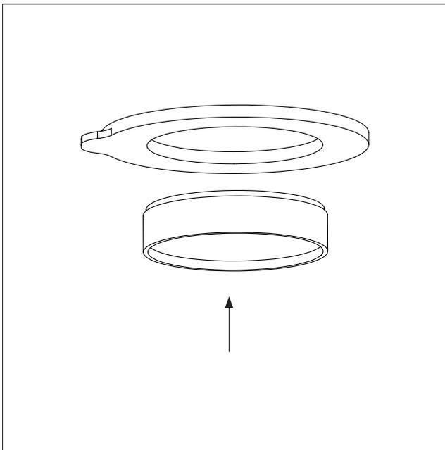
Montieren sie jede Linse auf einem Magnetiklinsen-Ring, indem Sie die Drähte von Linse und Ring verbinden.
