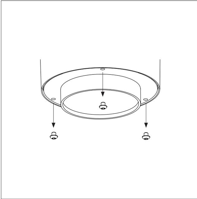
Demontieren Sie den aktuell unter dem Kamerakopf angebrachten Ring durch Lösen der drei Schrauben mithilfe des mitgelieferten Werkzeugs.
